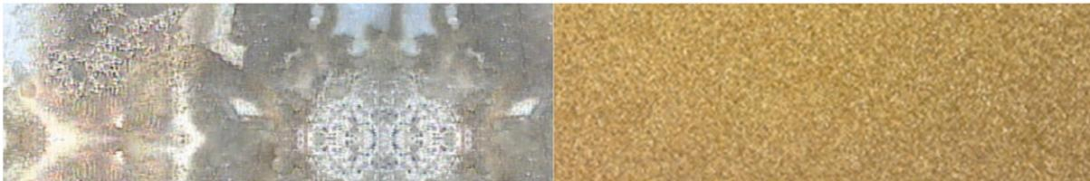
\* Resultado de la prueba: 360 horas después de exposición en cámara salina
